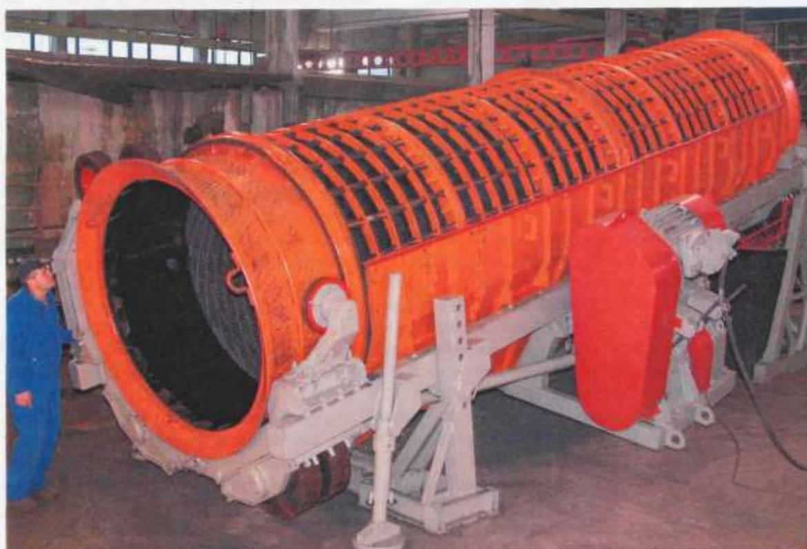
Рис. 1 - Общий вид грохота ГБК на стендовых испытаниях
