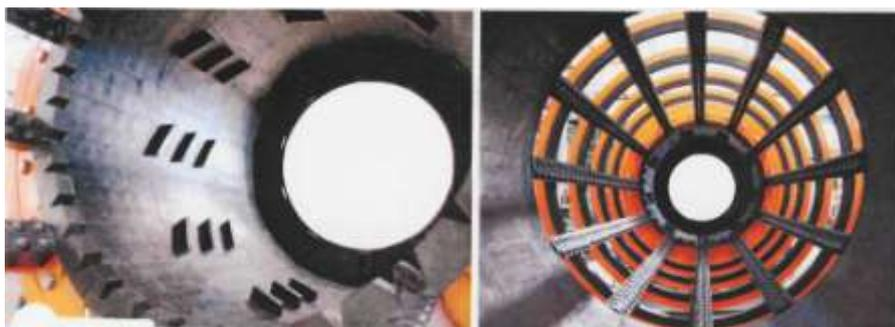
Рис. 14 - Рабочие поверхности секций грохота ГБР
