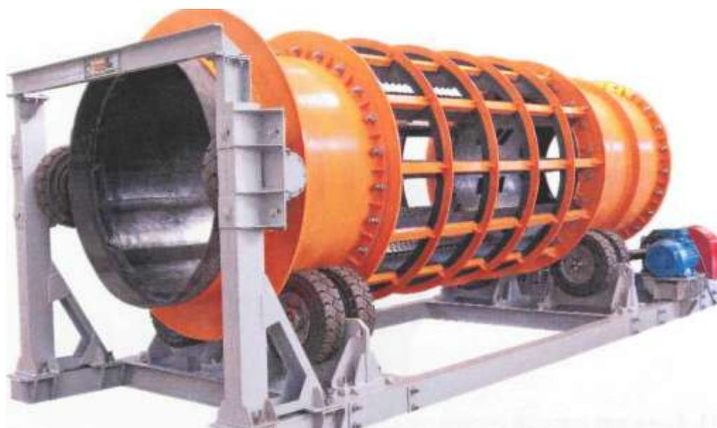
Рис. 13 - Грохот барабанный колосниковый ГБР для выделения и отмывки негабаритов крупностью +300 мм.
