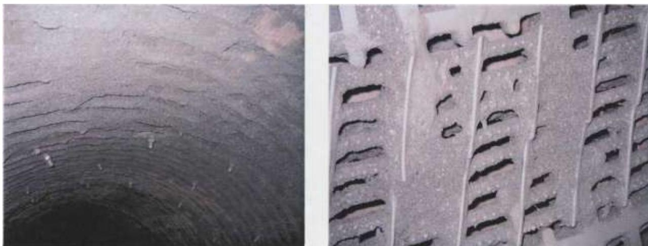
Рис. 4 - Налипания мелких фракций угля на первоначально применённых конструкциях просеивающих элементов СДАЛ с яч. 5 и 20 мм после суточной эксплуатации ГБК
