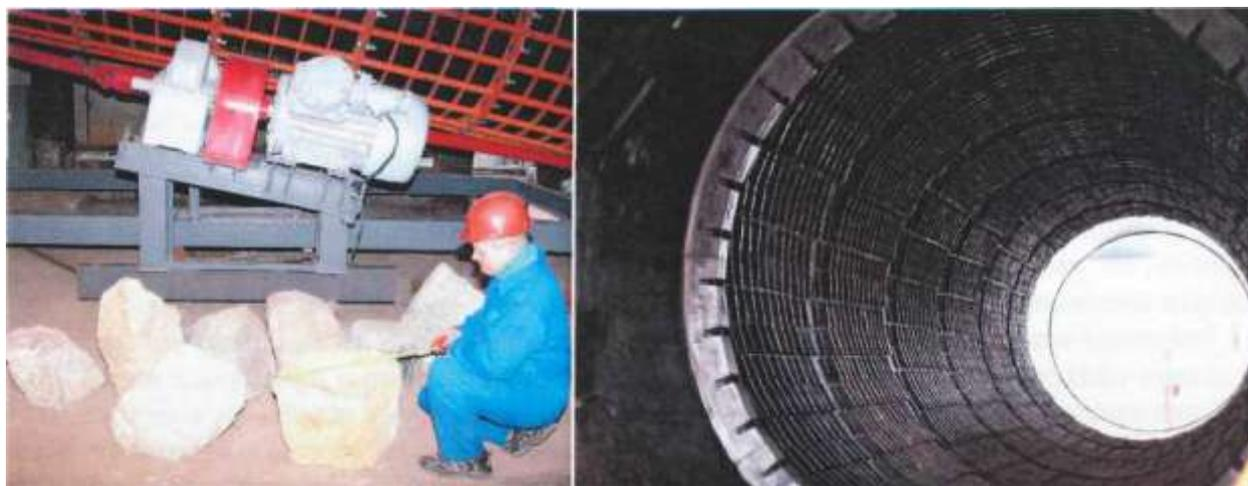
Рис.10 - Валун, применяемые при исследованиях и внутренняя рабочая поверхность грохота ГБА в заводских испытаниях.
